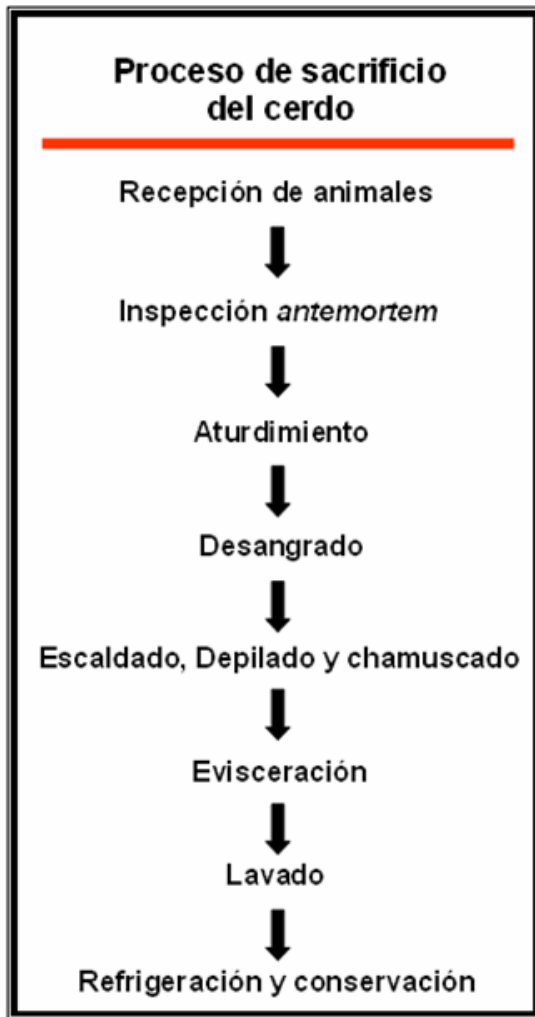
Figura 2. Diagrama de flujo de sacrificio del cerdo (Torrescano et al., 2007).
